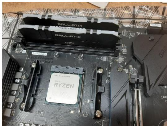
L'opération suivante consiste à mettre en place le système de refroidissement du processeur central. Afin d'obtenir une efficacité maximale, il convient de placer correctement de la pâte thermique entre le processeur et le ventilateur.
